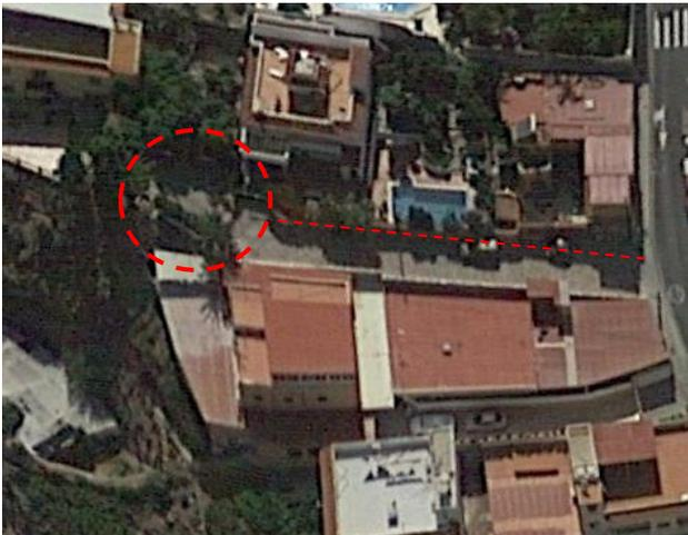
El trazado del viario no responde a la propuesta de planeamiento, además de ello debemos indicar que la rotonda que resuelve el fondo de saco no está ejecutada. La diferencia de cota existente en el punto final del trazado viario nos habla de una solución que va a requerir además de demoliciones parciales una modificación de la topografía del terreno para garantizar la ejecución de la rotonda indicada.
