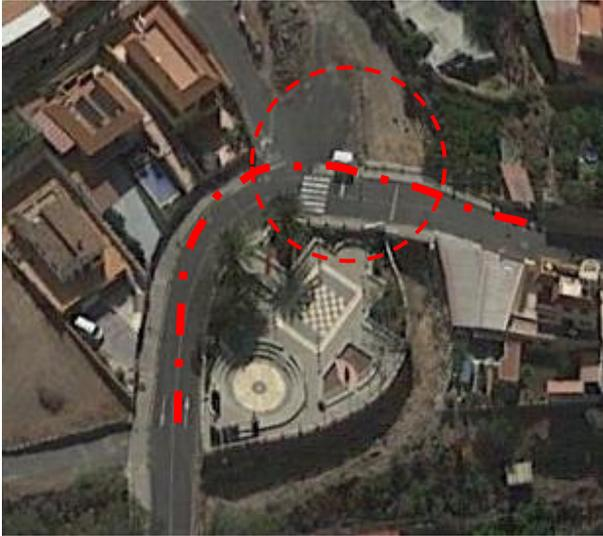
El trazado de la red viaria en planta difiere de forma clara con el previsto en planeamiento, ello nos obligará a realizar ajuste.
